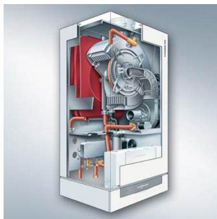
Bild 21: Gas-Brennwert-Wandkessel Vitodens 200 mit Inox-Radial-Heizflächen und Edelstahl-Zylinderbrenner
