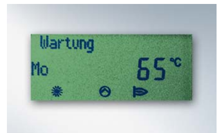
Bild 77: Die Wartungsanzeige informiert den Betreiber über die anstehende Wartung
